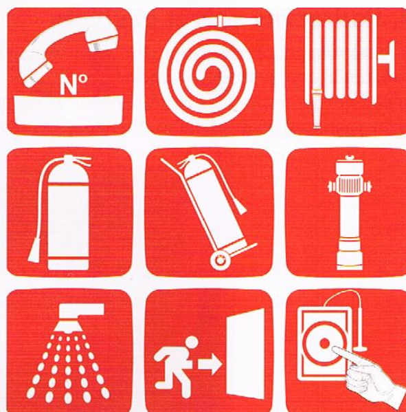
Rys. 27.2. Przykłady znaków ochrony przeciwpożarowej
