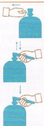
Ryc. 13.3. Zasady użycia gaśnicy proszkowej GP-1Z-BC
