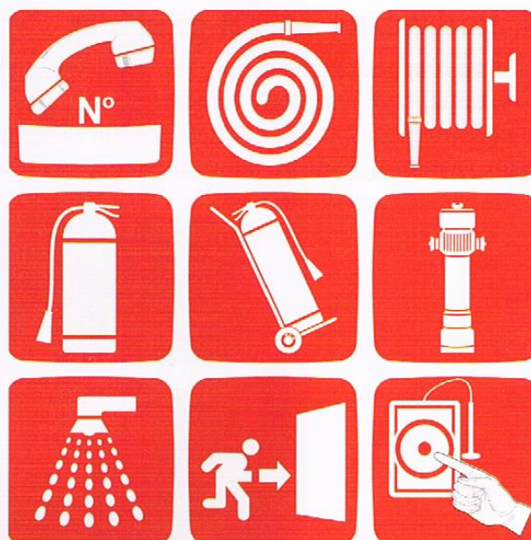
Rys. 27.2. Przykłady znaków ochrony przeciwpożarowej
