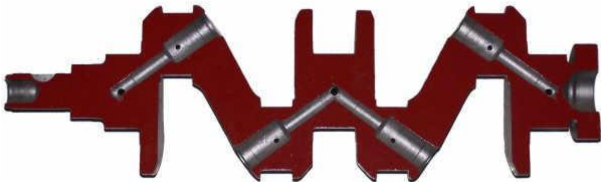
Zdjęcie 1 - wał korbowy w przekroju
