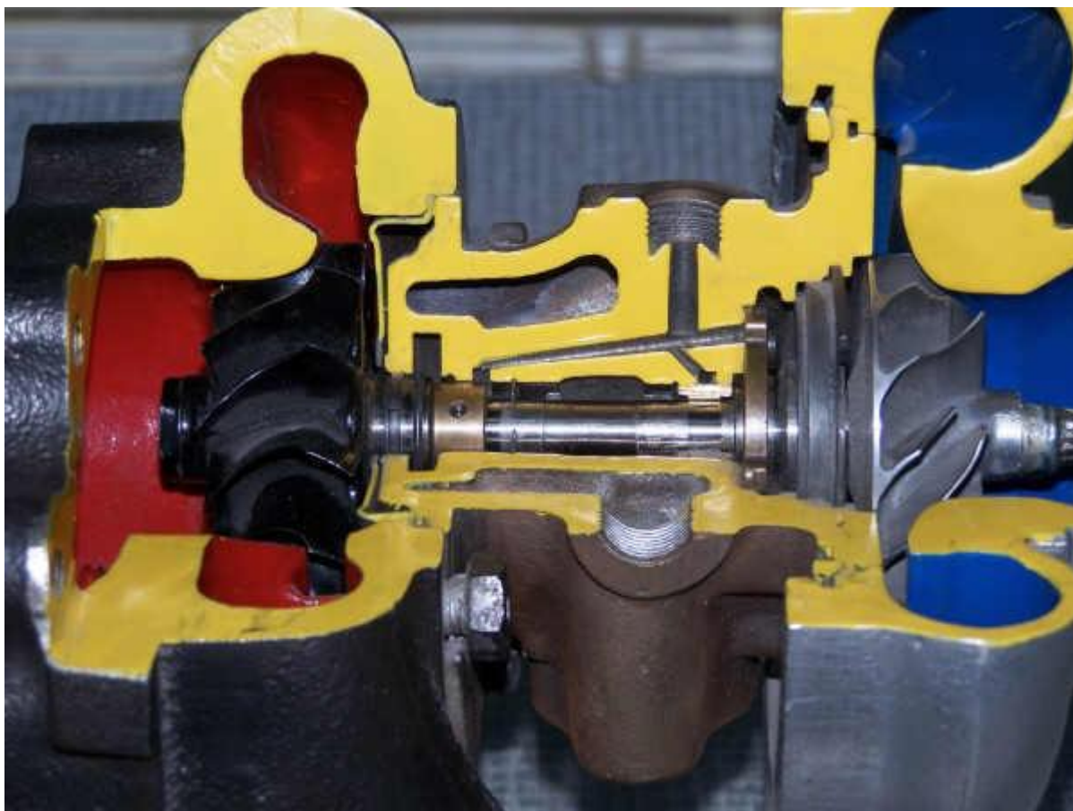
Zdjęcie 8 - sposób smarowania turbosprężarki
