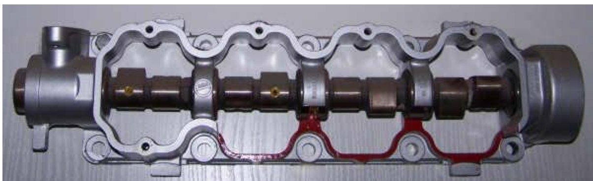
Zdjęcie 4 - osadzenie wałka rozrządu
