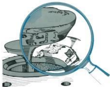
Rys. 1. Typowe ubytki materiału na przyłgniach zaworu i gniazda zaworowego.
