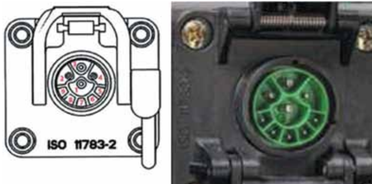
Oznaczenie pól w gnieździe i wtyczce przyłączy do szyny ISOBUS.
